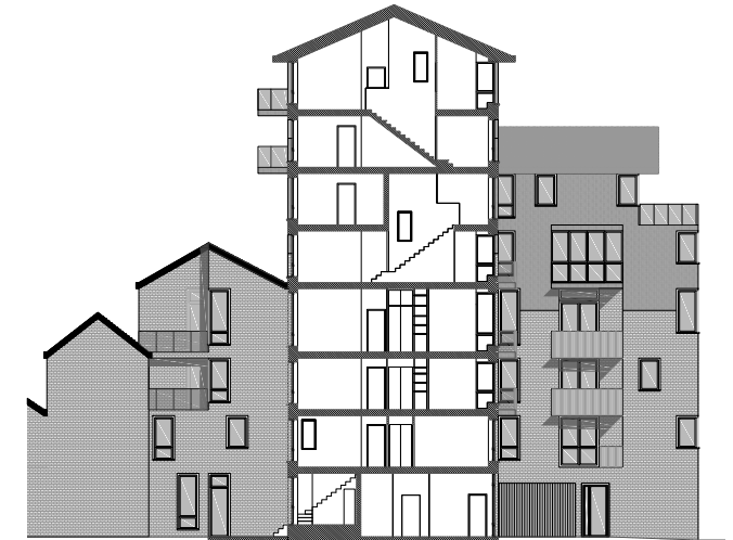
Installer des duplex dans le volume haut de 8 niveaux_Vue de la façade Nord
